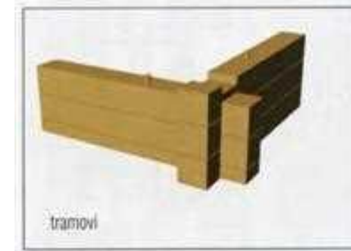
Klade: bruna, polovična bruna in tramovi, zložene ena na drugo so v vogalih zvezane s križanjem. (Vir: Deu, 2019, str. 78)
