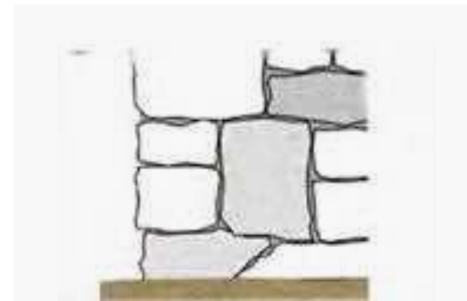
Stena iz grobo obdelanega kamna.
