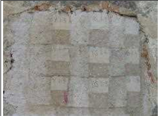
Pred izvedbo pripravimo vzorce ometa z različnimi peski in različnimi razmerji z apnom. Ko se posušijo, izmerimo Ph in izberemo najustreznejšo barvo.
