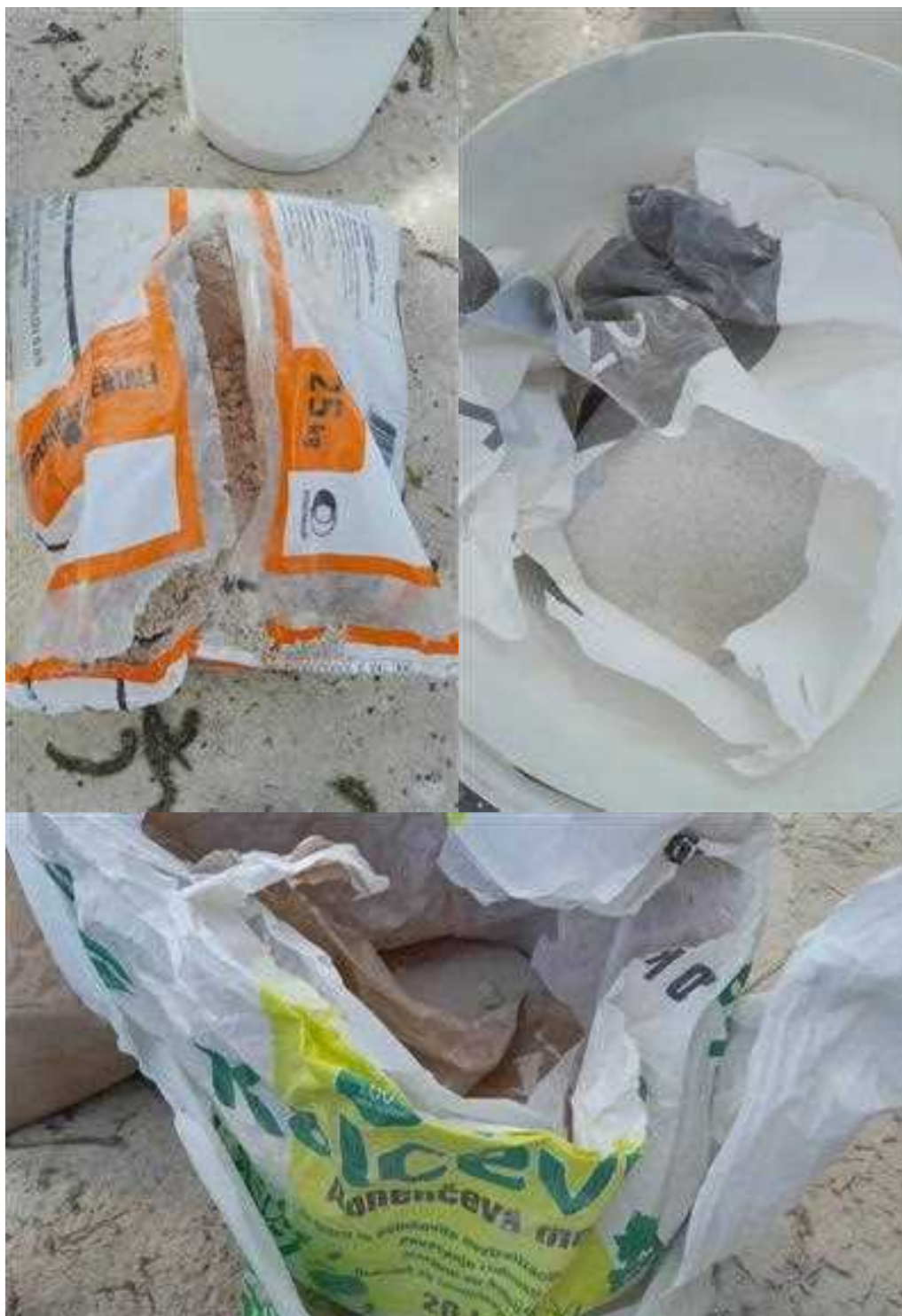
Slika 6: različne fine frakcije (mivka) za pripravo fine apnene malte
