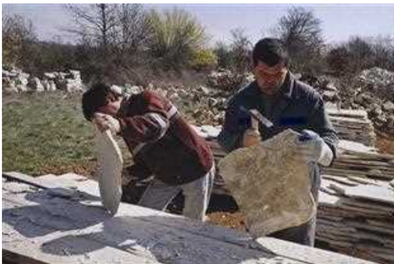
Slika 70 Delavca firme Kapitel v Žminju kar na prostem obdelujeta strešne skrile iz Benkovca.
