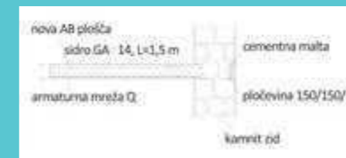
Sidranje nove AB plošče v stari zid. Vir: Arhiv Mojca Jarc Simonič
