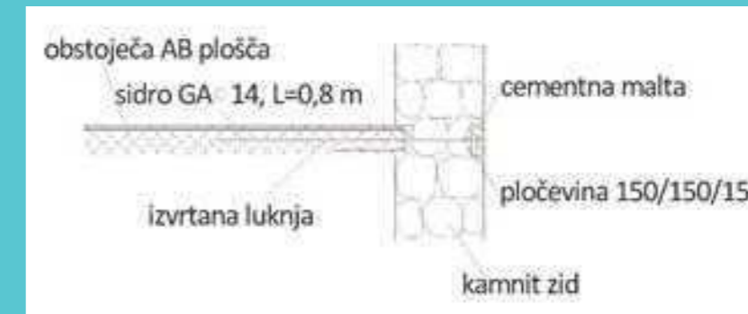
Izvedba sidranja obstoječih AB plošč • Vir: Arhiv Mojca Jarc Simonič
